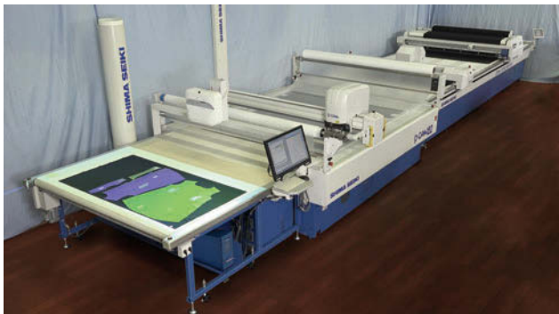
自動裁断機と自動延反機を組み合わせた「Total Cutting Solution」
